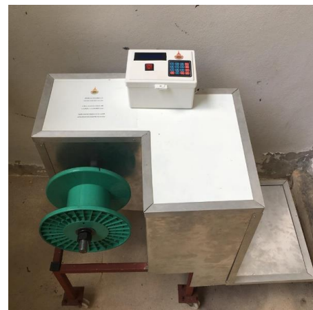
รูปที่ 5 เครื่องวัดความยาวสายและตัดสาย LAN
