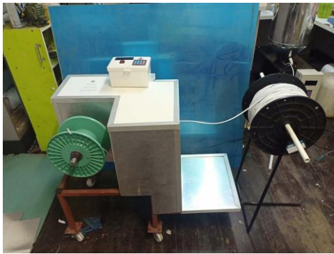
รูปที่ 5 ทอหลอดวัดระยะสายและตัดสาย LAN
